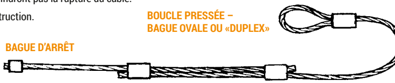
PRESSAGE SUPERPOSÉ - BAGUES OVALES OU «DUPLEX»
